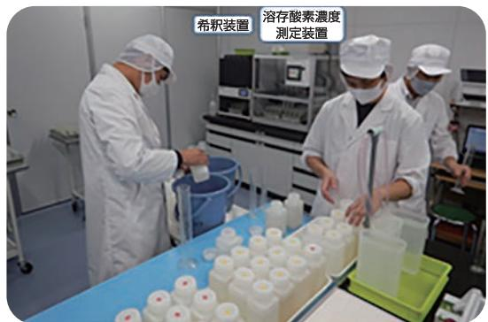
BOD検査室の様子(検体の仕込み作業)
